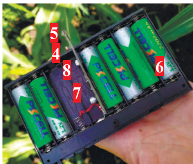
Рис. 19. Съемный блок — кассета со снятой крышкой. Снаружи — сенсор для измерения освещенности среды (4) и плата с двумя светодиодами УФ излучения (5). Внутри — съемные аккумуляторы в качестве источника питания (6 штук) (6), энергонезависимая память (микроконтроллер Attiny 13A) с записанной программой управления светодиодами (7), кнопка для программирования устройства (8)
