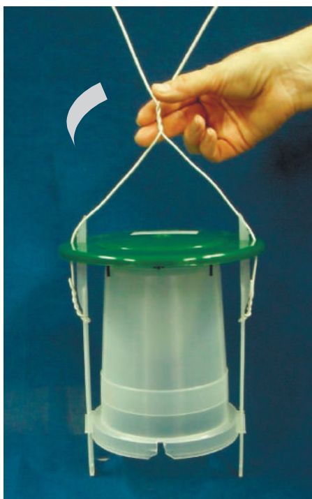
Рис. 10. Установка крышки над воронкой (следует вставить направляющие планки вместе с проволоками в отверстия с двух сторон)
