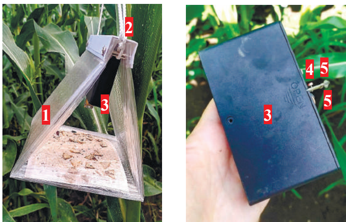
Рис. 18. Светодиодная клеевая ловушка «Дельта» – пластиковый прозрачный корпус (1), веревка для подвешивания ловушки (2) и съемный блок – кассета со съемной крышкой (3), несущая сенсор для определения освещенности среды (4), светодиоды УФ излучения (5) и системы управления и питания (внутри под крышкой)
