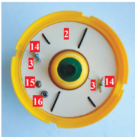
Рис. 22. Светоферомонная ловушка с отстегнутым контейнером (вид на воронку снизу). Плата (2) крепится гайками (14) на резьбовых шпильках (3). Электрическая часть ловушки включается с помощью тумблера (15). Для зарядки аккумуляторов используется гнездо (16)
